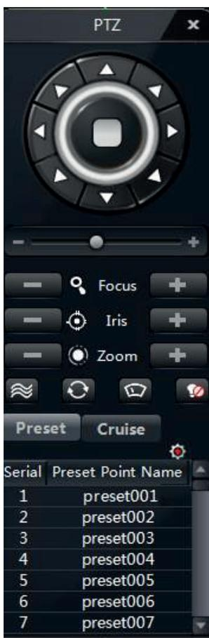
Nota: O protocolo, baud rate e endereço do PTZ devem ser consistentes com o decodificador do PTZ.
