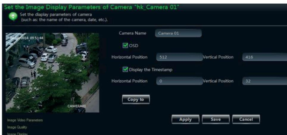
Crie um nome de câmera e configure sua posição de exibição nos elementos da tela, incluindo a marca de horário. Clique em “Copy to” (“Copiar para”) para aplicar as configurações no canal selecionado.
