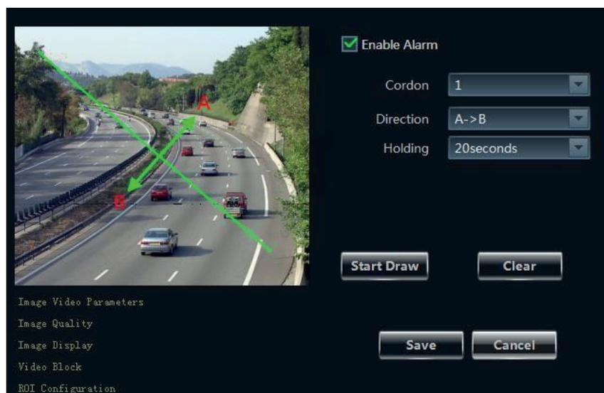
Clique em Edit Camera Settings (“Editar Configurações da Câmera”) sob Device (“Dispositivo”) no painel de controle para ir à interface de area & camera management (“área & gerenciamento de câmera”). Selecione uma câmera da esquerda e então clique em “Line Crossing” (“Travessia de Linha”) sob Intelligent Event Settings (“Configuração de Evento Inteligente”) para ir à interface ilustrada à direita.
